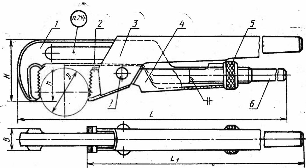
1 — подвижной рычаг; 2 — губка; 3 — неподвижный рычаг; 4 — поводок; 5 — гайка; 6 — рукоятка подвижного рычага; 7 — ось (заклепка по ГОСТ 10299—80).
