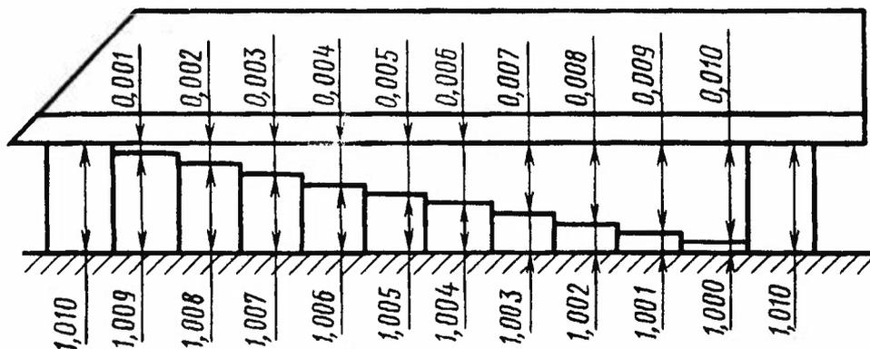
Концевые меры притираются к плоской стеклянной пластине, как показано на чертеже. На поверхности концевых мер, кроме крайних, наносится слой краски. После этого, используя лекальную линейку 0-го класса типа ЛД по ГОСТ 8026, счищают краску с промежуточных концевых мер, опираясь на две крайние меры. Оставшийся слой краски будет иметь толщину: на первой мере — 1 мкм, на второй мере — 2 мкм и т.д. Концевые меры при этом будут различаться по интенсивности окраски.
